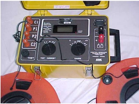
**Figura 15** equipo medidor de puesta a tierra
